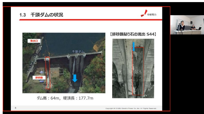
写真 2.8 千頭ダム排砂路の損傷状況
