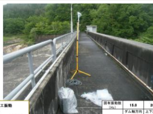
常時微動 計測によ る健全性 調査
